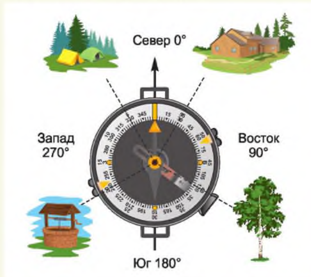
Рисунок 5.2. Определение сторон горизонта по компасу
