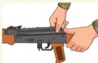
Рисунок 4.7. Отделение крышки ствольной коробки
