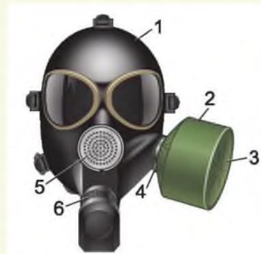
Рисунок. 8.7. Противогаз ПМК-3 (противогаз малогабаритный комбинированный): 1 – лицевая часть; 2 – узел клапана вдоха; 3 – фильтрующе-поглощающая коробка; 4 – трикотажный чехол; 5 – переговорное устройство (мембрана); 6 – узел клапана выдоха
