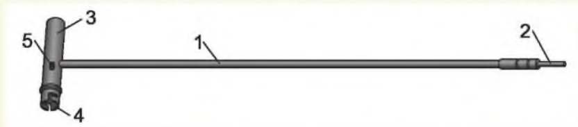
Рисунок 4.29. Принадлежность автомата, подготовленная для чистки ствола: 1 – шомпол; 2 – протирка; 3 – пенал; 4 – отвертка; 5 – головка шомпола
