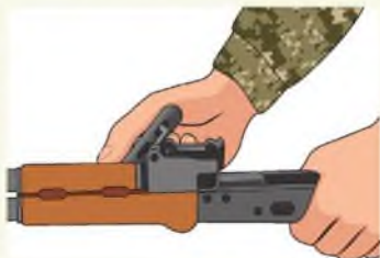
Рисунок 4.11. Поворот замыкателя газовой трубки с помощью принадлежности
