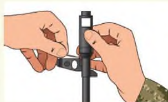
Рисунок 4.6. Отделение дульного тормоза-компенсатора
