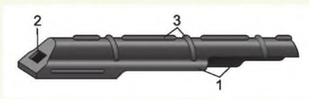
Рисунок 4.16. Крышка ствольной коробки: 1 – ступенчатый вырез; 2 – отверстие; 3 – ребра жесткости
