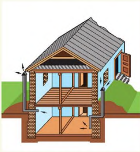
Рисунок 8.16. Подвал, приспособленный под укрытие
