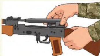
Рисунок 4.9. Отделение затворной рамы с затвором
