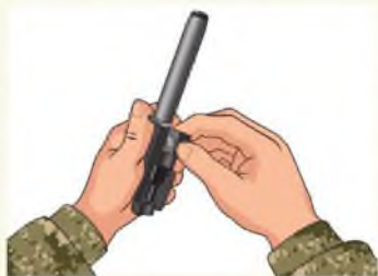
Рисунок 4.10. Отделение затвора от затворной рамы
